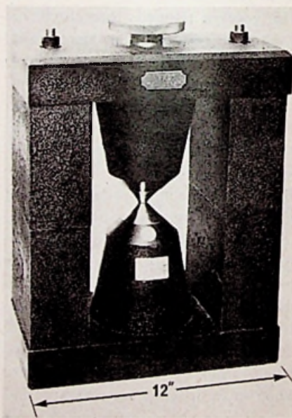
Een permanente magneet met een veld van 36 kilogauss, geproduceerd door Preformations Ltd.
