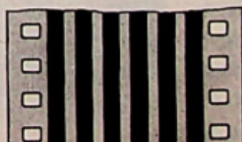
3.5 35-mm-Magnetfilm mit Sechsspur-Atelierschrift
