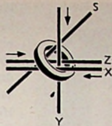
Figuur 15. Bedrading van een geheugenring
